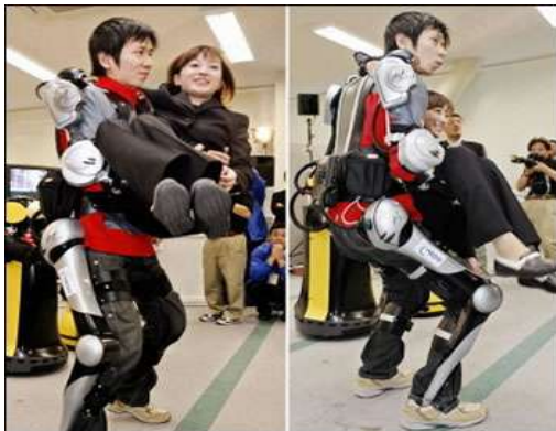
Robot Suit รุ่น HAL-5 (Hybrid Assistive Limb) ผู้สาธิตอุ้มสาวเพื่อสาธิตการหาค่า EMG เพื่อสร้างสมดุลย์ให้ร่างกาย. ภาพจาก: www.technovelgy.com
