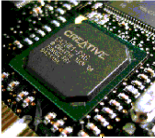
ภาพแสดง CA20K1 ซึ่งเป็นชิป DSPs คุมพลังการประมวลผลของ X-Fi ที่มา: www.overclockzone.com
